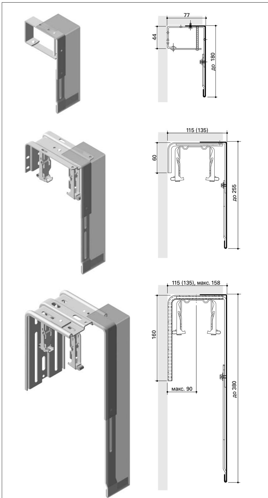
Комбинированный кронштейн с высотой основания 44 мм, глубина бленды 77 мм
